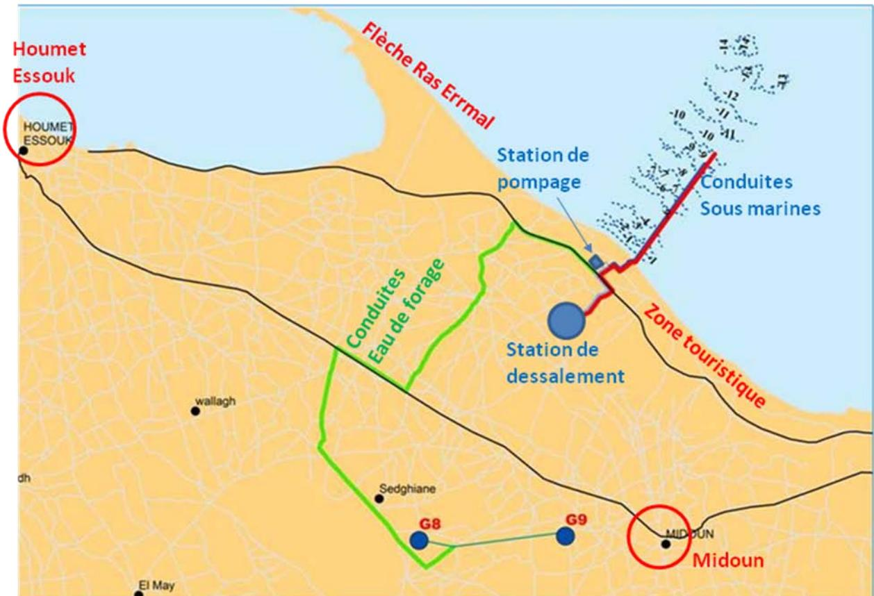
Figure 56 : Tracé de la conduite d'adduction des eaux de forage de reminéralisation
