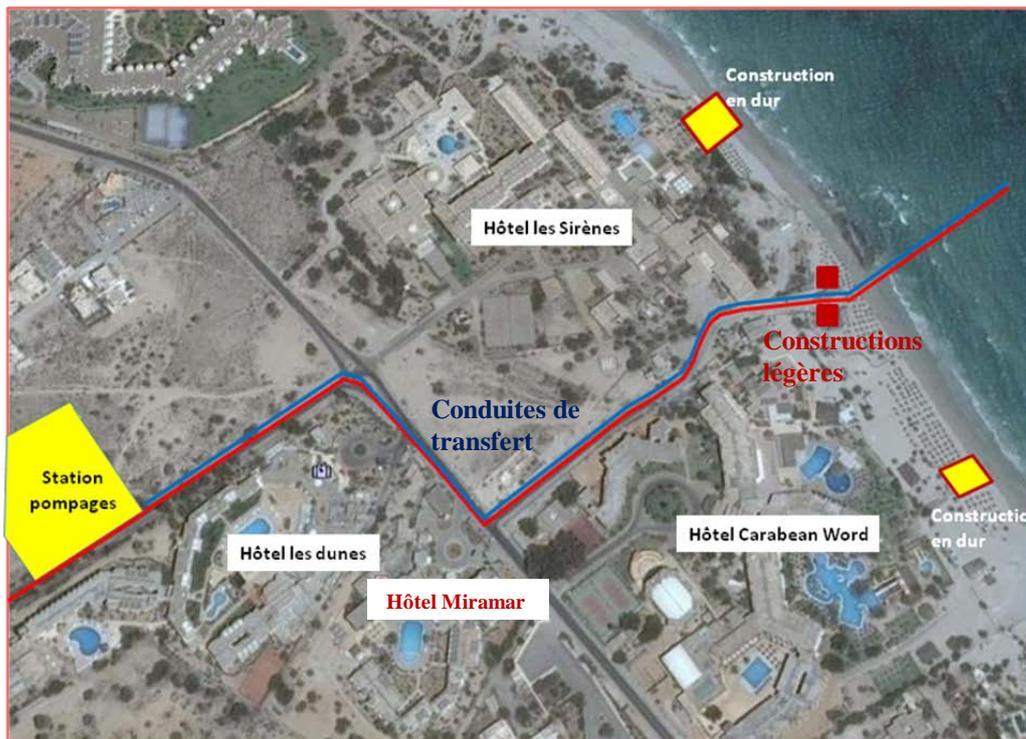
Figure 86 : divers obstacles rencontrés dans le dernier tronçon terrestre des conduites de transfert
